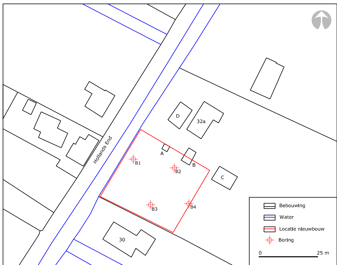
Afb. 2: Onderzoekslocatie en boringen. A = fietsenhok, B = ketelhuis, C = Kas, D = uitgebrande woning 32a.
